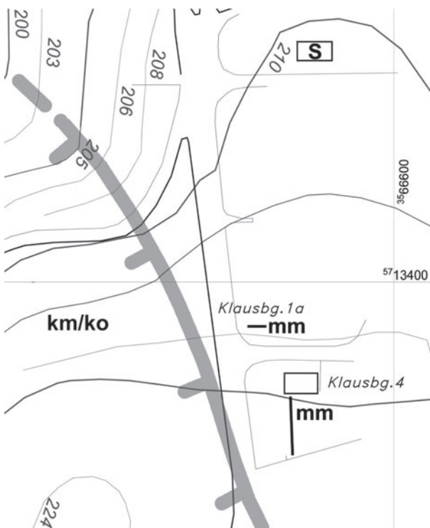
Abbildung 4. Karte der temporären mm-Aufschlüsse, Nordostrand Klausberg; in Baugrube Haus Nr. 34 wurden sehr harte Bankkalke angetroffen, wohl Schaumkalkbereich oberster mu (S'); wahrscheinlicher Verlauf der Hauptabschiebung.
