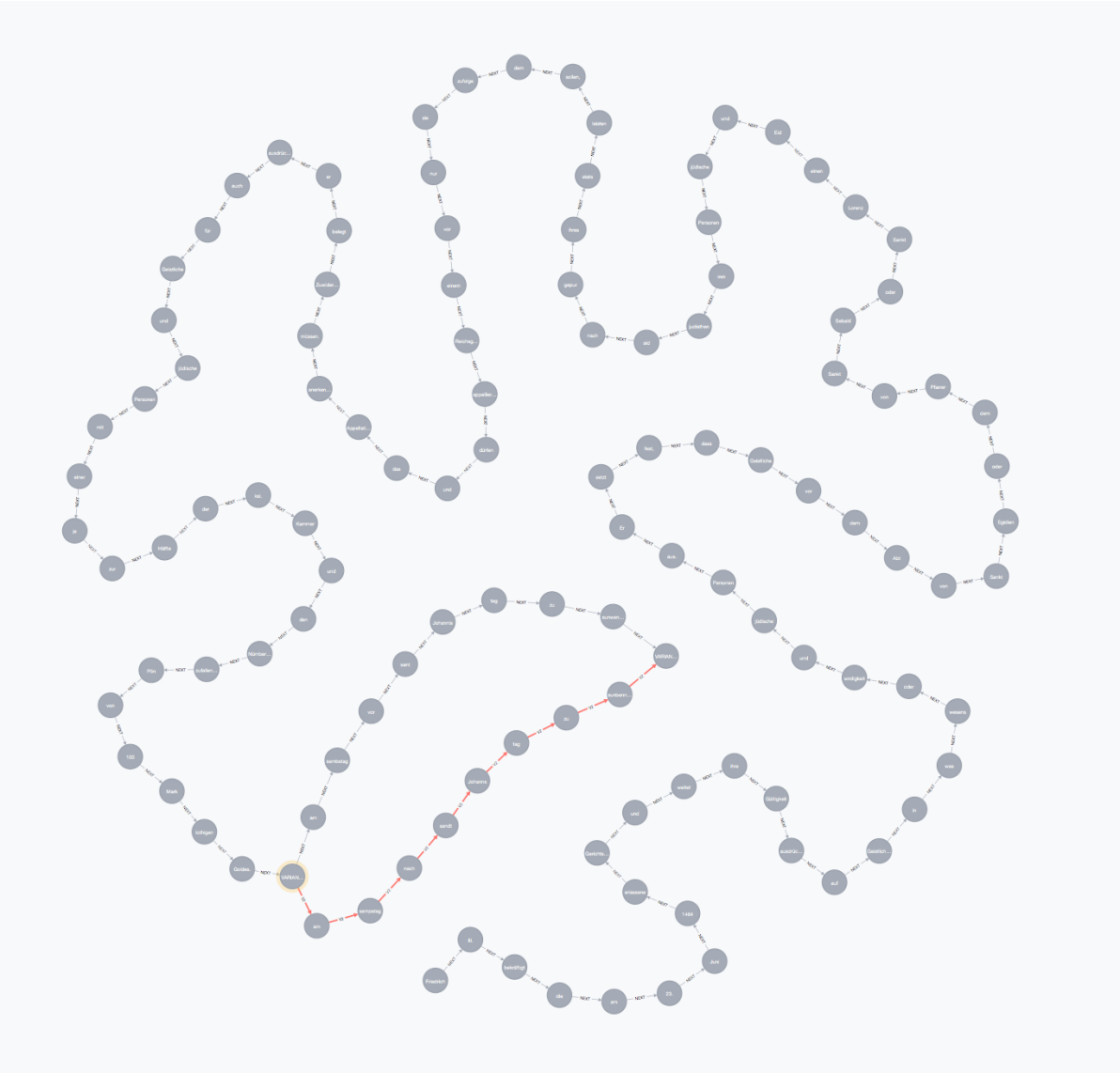
Abbildung 3: Ein Text dargestellt als eine Kette von Knoten in einem Graphen, verbunden mit NEXT-Kanten, die jeweils auf das nächste Wort zeigen (Quelle: Kuczera).
