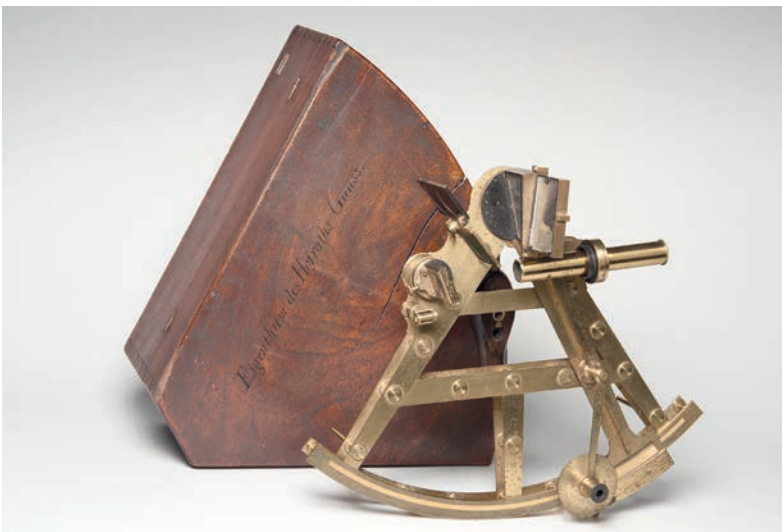
Vizeheliotrop zur Umlenkung des Sonnenlichtes (griech. »Heliotrop«). Gefertigt: Werkstatt E. Troughton (1753–1835), London, Umbau 1821 durch C. F. Gauß (1777–1855). Der Vizeheliotrop war auf dem 10 DM-Schein abgebildet. Foto: Stephan Eckardt
