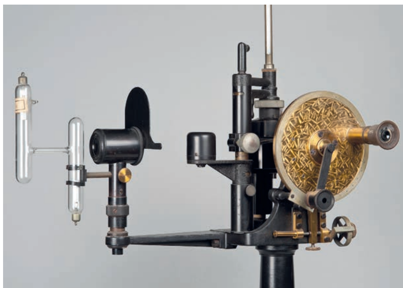
Refraktometer nach Pulfrich, Carl Zeiss, Jena, 1895. Foto: Stephan Eckardt
