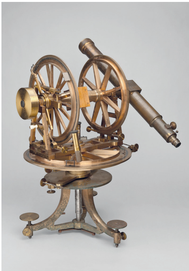
Theodolit von Reichenbach und Ertel. 1820 von Gauß angeschafft und bei der Hannoverschen Gradmessung verwendet, Messing, Glas etc., Höhe: 66 cm. Foto: Stephan Eckardt
