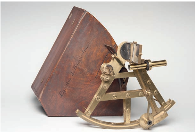
Vizeheliotrop zur Umlenkung des Sonnenlichtes (griech. »Heliotrop«). Gefertigt: Werkstatt E. Troughton (1753–1835), London, Umbau 1821 durch C. F. Gauß (1777–1855). Der Vizeheliotrop war auf dem 10 DM-Schein abgebildet. Foto: Stephan Eckhardt
