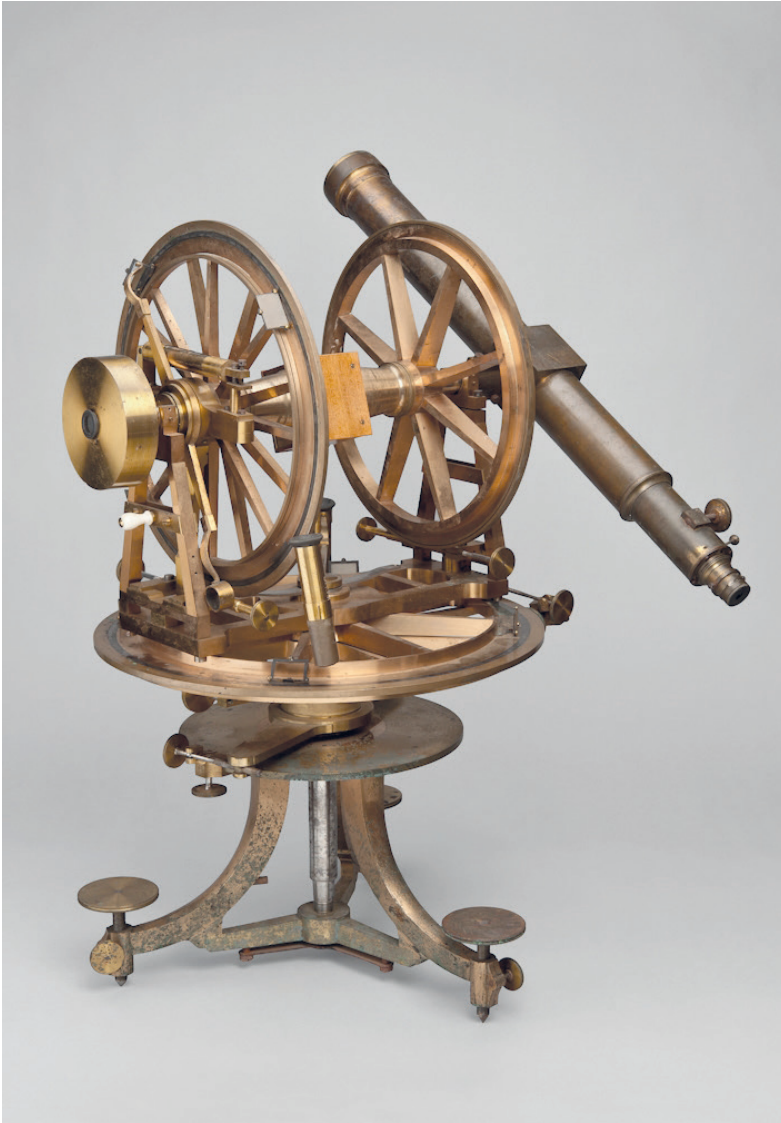
Theodolit von Reichenbach und Ertel (1947). 1820 von Gauß angeschafft und bei der Hannoverischen Gradmessung verwendet
